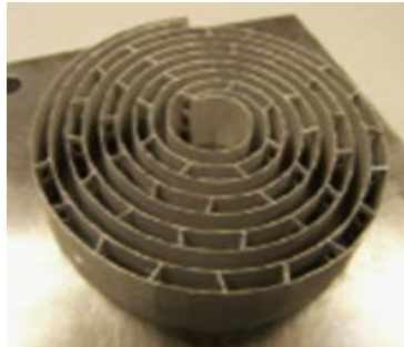
Figure 2-12. Pièce industrielle fabriquée par le biais de la technologie SLM par le centre de recherche IK4-LORTEK.
