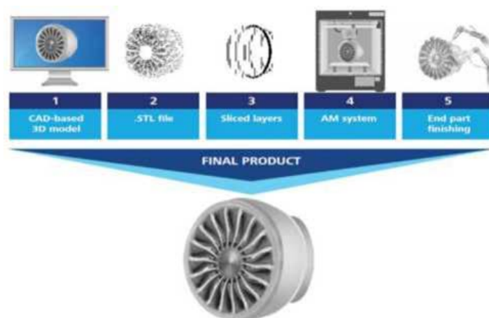
Figura 3-1. Fluxo do processo AM. [39]
