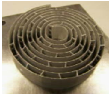
Gráfico 2-12. Pieza industrial fabricada con la tecnología SLM en el Centro de Investigación IK4-LORTEK.
